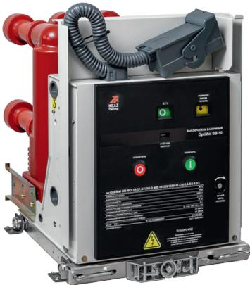
Выключатели предназначены для коммутации электрических цепей в нормальных и аварийных режимах в сетях трехфазного переменного тока частотой 50 Гц номинальным напряжением 6, 10 кВ и в шкафах КРУ и КРУН, а также в системах быстрого автоматического ввода резерва (БАВР).
